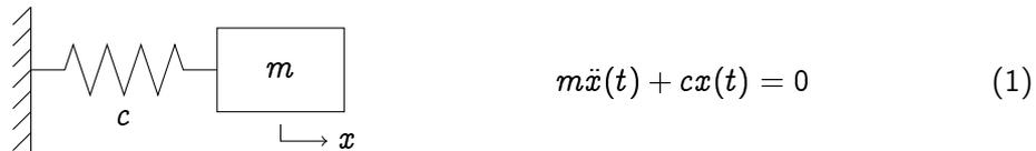
Ein Körper mit Masse  $m$  bewegt sich entlang der  $x$ -Achse. Eine Feder mit Steifigkeit  $c$  zieht ihn in Richtung  $x = 0$ . Die Kräftebilanz von Trägheits- und Federkraft führt auf die Bewegungsgleichung (1), die Differentialgleichung der ungedämpften freien Schwingung. Aus ihr lässt sich die Beschleunigung bestimmen, wenn die aktuelle Position bekannt ist:
