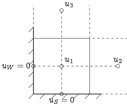
Der Gradient  $\nabla u$  an den Grenzflächen wird durch Differenzenformeln genähert. Für die Ostfläche der ersten Zelle ist
