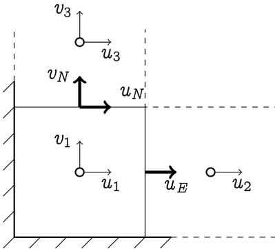
Für die erste Zelle ist das Oberflächenintegral eine Summe über Ost- und Nordfläche. Die Beiträge sind (Interpolation gemäß Gleichung (1))
