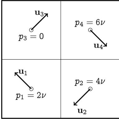
Dabei ist noch zu beachten: Das Gleichungssystem ist singular, die Druck-Lösung ist nur bis auf eine frei wählbare Konstante bestimmt. Hier ist  $p_3 = 0$  gesetzt.
