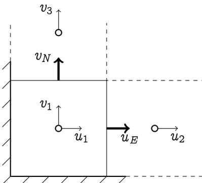
Für die erste Zelle liegt folgende Situation vor: Durch die Ostfläche strömt Fluid mit Geschwindigkeit  $u_E$ , durch die gleich große Nordfläche mit  $v_N$ . An Süd- und Westgrenze sind feste Wände. Das Fluid ist inkompressibel, es befinden sich keine Quellen oder Senken in der Zelle, in Summe muss der Durchfluss gleich Null sein: es folgt also  $u_E + v_N = 0$ .
