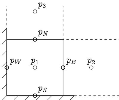
An der Ostseite mit Flächeninhalt  $A_E = 1/2$  wirkt die Druckkraft  $\mathbf{F}_E$  mit Betrag  $p_E A_E$  in Richtung des Ostflächen-Normalvektors. Wir interpolieren  $p_E$  als Mittelwert der benachbarten Zellzentrums-Drücke.
