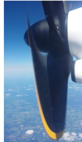
Auf dem Video dreht sich der Propeller scheinbar recht langsam. Wenn Sie genau hinsehen und auf den Anstellwinkel der Propellerblätter achten, dreht er sich sogar rückwärts! Keine Panik, das sind Aliasing-Effekte. Die tatsächliche Propellerdrehzahl können Sie aus dem Betriebsgeräusch durch Fourieranalyse ermitteln. Der Befehl
