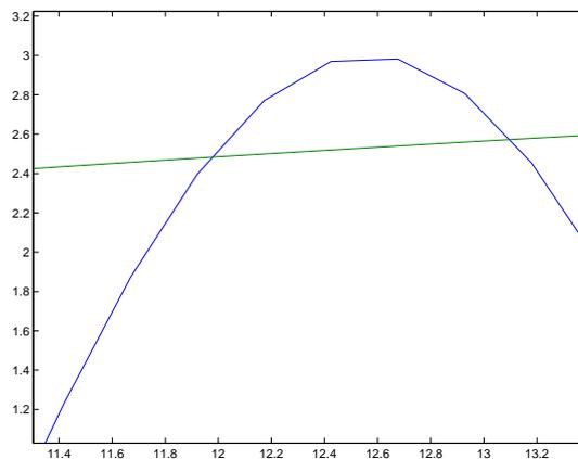
Die Vergrößerung zeigt aber auch, dass nicht die „wirklichen“ Funktionen dargestellt werden, sondern die einzelnen Datenpunkten der Vektoren  $x$ ,  $y$  und  $z$  stückweise durch Geraden verbunden sind. Deswegen kann man aus der Graphik die Lösungen der Gleichung  $3 \cos x = \log x$  natürlich nur im Rahmen der Zeichengenauigkeit darstellen.
