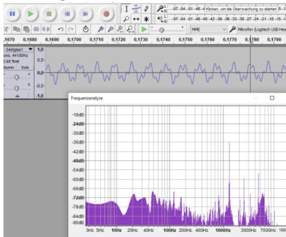
Bildschirmfoto einer Frequenzanalyse mit Audacity. Auch in MATLAB können Sie Frequenzanalyse durchführen. Siehe Demo Datei `FourierSektglas.m`
