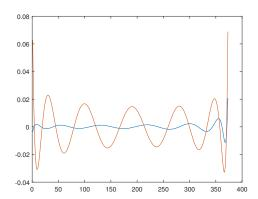
Hier ist ein Beispiel-Plot: Er zeigt für Polynomgrad 12 in blau den Fehler des Approximationspolynoms aus der QR-Zerlegung (Matlab-Befehle polyfit, polyval), in orange den entsprechenden Fehler bei der Methode der Normalengleichungen. Er ist signifikant größer; das kommt nur von den Rundungsfehlern. Bei Grad 11 gibt es noch kaum Unterschied. Normalengleichungen können Sie also bei diesem Datensatz ab Grad 12 vergessen. Wie sieht es mit den anderen beiden Methoden bei höheren Graden aus?
